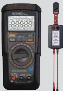
METRAHIT COIL Адаптер для тестирования обмоток электродвигателя
