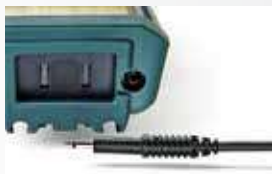
Подключение внешнего блока питания и работа от сети без использования батареек
